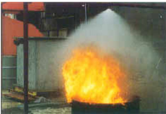
水噴霧による油火災の消火試験
