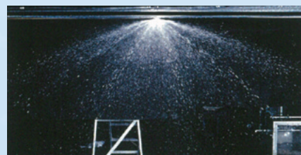
スプリンクラーヘッドからの放水状況
