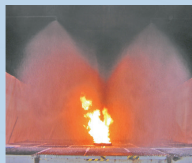
特殊水噴霧消火設備
